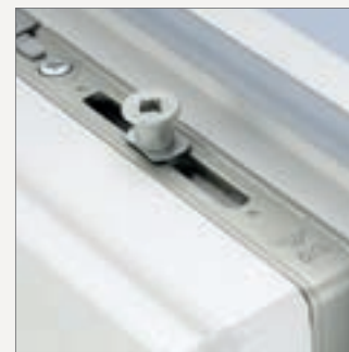
2 PILZZAPFEN-VERRIEGELUNG Zapfenkopf greift hinter das Schließblech.
