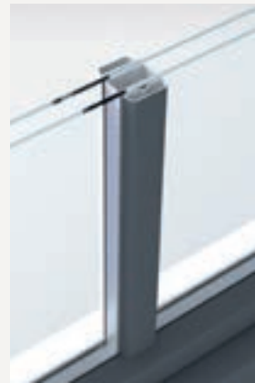
Aufmontierte Sprosse mit Aludeckschale und Glassteg , 26, 35 oder 50 mm breit. Vorteil des innenliegenden Glasstegs: Optisch wirkt die Sprosse glasteilend.
