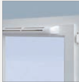
AIROMAT – für größeren Luftbedarf werden Schlitze in den Rahmen gefräst und der Lüfter aufmontiert.
