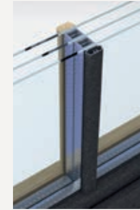
Aufmontierte Holz-/Aluminium-Sprosse mit Glassteg , 26, 32 oder 36mm breit. Vorteil des innenliegenden Glasstegs: Optisch wirkt die Sprosse glasteilend.
