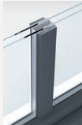
Aufmontierte Sprosse mit Aludeckschale und Glassteg , 26, 35 oder 50 mm breit. Vorteil des innenliegenden Glasstegs: Optisch wirkt die Sprosse glasteilend.
