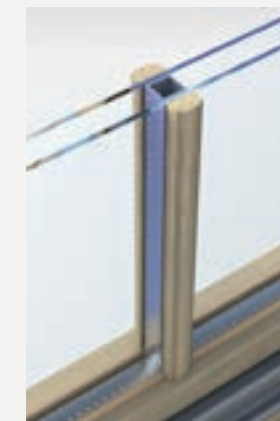
Aufmontierte Sprosse mit Glassteg , 25-45 mm breit. Vorteil des innenliegenden Glasstegs: Optisch wirkt die Sprosse glasteilend. Links die normale Sprosse, mittig Sprosse mit Hohlkehle, rechts Sprosse mit S-Profil.
