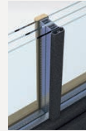
Aufmontierte Holz-/Aluminium-Sprosse mit Glassteg , 26, 32 oder 36mm breit. Vorteil des innenliegenden Glasstegs: Optisch wirkt die Sprosse glasteilend.
