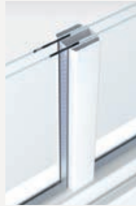
Aufmontierte Sprosse mit Glassteg , 26, 35 oder 50 mm breit. Vorteil des innenliegenden Glasstegs: Optisch wirkt die Sprosse glasteilend.
