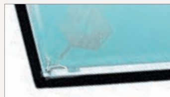
GLASBRUCHMELDER Alarmspinnen oder Sensoren erkennen und melden den Bruch einer Fensterscheibe.
