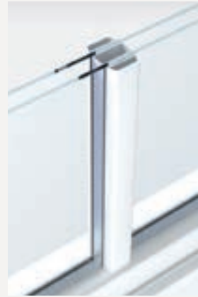
Aufmontierte Sprosse mit Glassteg , 26, 35 oder 50 mm breit. Vorteil des innenliegenden Glasstegs: Optisch wirkt die Sprosse glasteilend.
